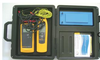
Mallette de détection avec émetteur, détecteur, support
